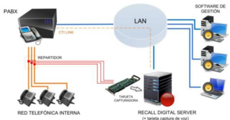
PC Servidor equipado con una o varias tarjetas de captura de voz en formato PCI o PCIe y conectadas al repartidor de la centralita.
